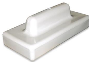
EF1010 Flotación Extra 29.5" x 14" x 9.5" (74.9 cm x 35.5 cm x 24.1 cm) Flotabilidad adicional: 60 lbs (27.21 kg) Peso: 9 lbs (4.08 kg) Se desliza debajo del modulo para proveer flotación adicional cuando sea necesario.
