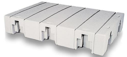
FS1030 45" x 30" Sección Flotante 45" x 30" x 10" (114.3 cm x 76.2 cm x 25.4 cm) Flotabilidad Máxima por Módulo: 325 lbs (147 kg) Peso: 50 lbs (22.68 kg) Sección de flotación pequeña, equivalente a la mitad del FS1060, ideal para cuando se necesita superficies de menor longitud.
